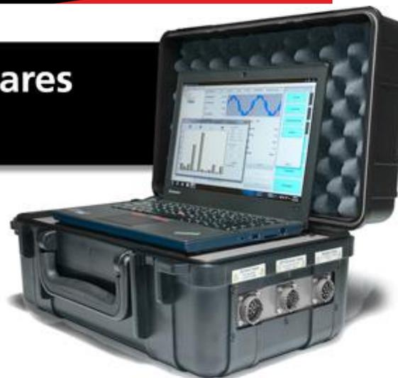
El equipo **Megger Baker EX4000** monitorea y registra voltajes y corrientes de los motores para separar los problemas mecánicos y eléctricos que pueden presentarse en un sistema Energía-Motor-Carga. Mediante el monitoreo de diferentes parámetros y el uso de un algoritmo avanzado, el EXP4000 es diseñado para determinar con precisión los desafíos en el sistema, incluyendo aquellos en la fuente de energía, variadores de velocidad, el motor y la carga.
