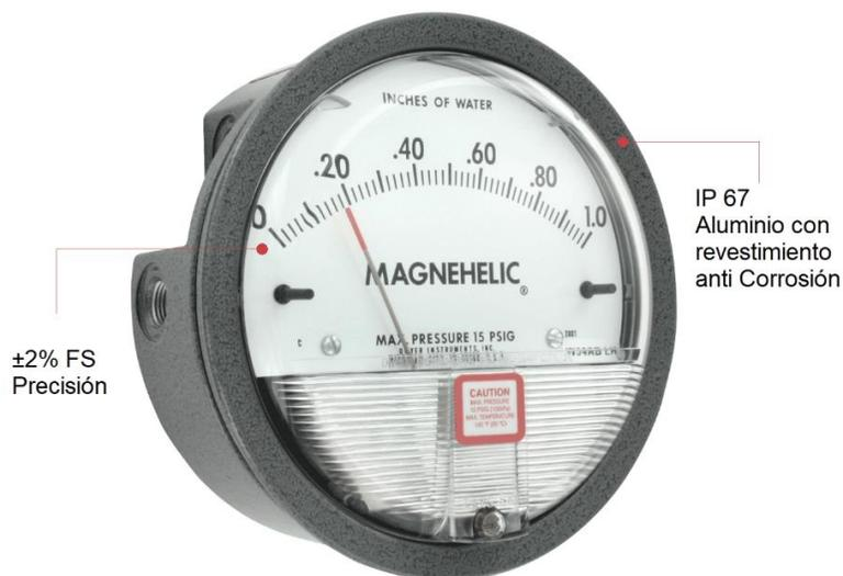
El medidor Magnehelic® SERIE 2000 es un medidor versátil de baja presión diferencial con una amplia variedad de 81 modelos y 27 opciones para elegir. El sencillo movimiento sin fricción del medidor Magnehelic® de Dwyer, permite indicar rápidamente presiones, ya sean positivas, negativas (vacío) o diferenciales, de aire y gases no corrosivos.
