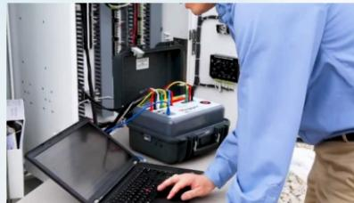
El MRCT puede configurarse para incluir la funcionalidad de realizar una prueba de excitación en TC utilizando tensión continua, lo que permite medir puntos de inflexión en TC de hasta 30 kV. Además, se puede configurar para probar los VT y los relés monofásicos.
