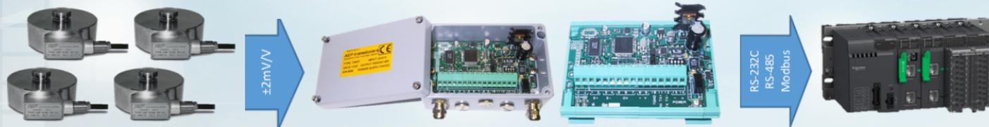
El transmisor TA5F, ahora con entrada bipolar, hace sencilla y económica la transmisión remota de los valores de: células de carga de "strain gauges", transductores de par, etc. a PLC, PC, registradores, u otros equipos.
